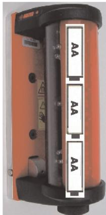
Il ricevitore richiede l'inserimento di 3 batterie St AA. Svitare il coperchio nero ubicato nella parte inferiore dell'apparecchio per sostituire le batterie e posizionare i nuovi elementi nella posizione indicata. La durata d'esercizio è pari a circa 130 ore.
