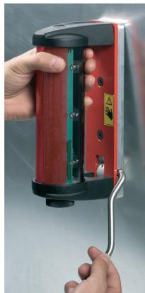
Antes de conectar el receptor al brazo mecánico, bascle la palanca de desacoplamiento hacia abajo. Esta maniobra crea un espacio entre la tarjeta maestra y la máquina y evita que el imán se adhiera totalmente al metal.
