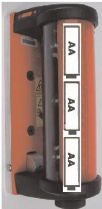
El receptor necesita 3 pilas estándar AA. Destornille la tapa negra situada debajo del aparato para cambiar las pilas y sustitúyelas en la posición indicada. La vida útil es de aproximadamente 130 horas.
