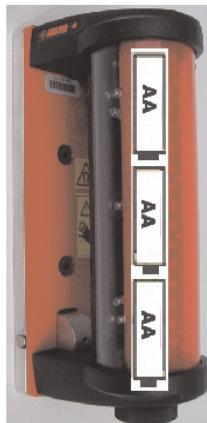
Der Empfänger braucht 3 St. AA-Batterien. Schrauben sie die schwarze Kappe unten am Gerät ab um die Batterien auszutauschen; angeordnet wie beschrieben. Die Betriebsdauer beträgt ca. 130 Stunden.
